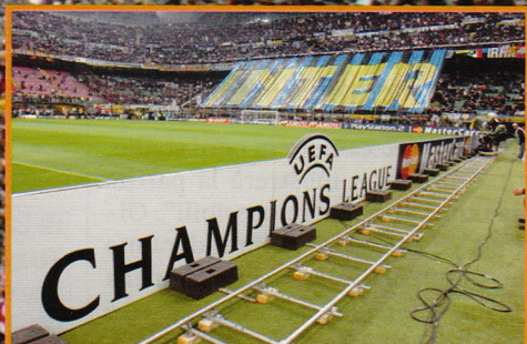
Binari di un "dolly", il carrello da ripresa: segue il movimento dei giocatori da bordocampo.
