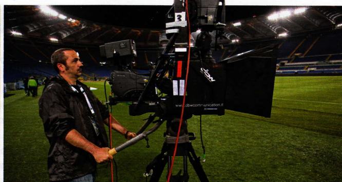
◀ Sguardi dal futuro. A sinistra, la Spidercam montata all'Olimpico di Roma per la finale di Coppa Italia. A fianco e sotto, due telecamere per riprese "live" in tre dimensioni.
